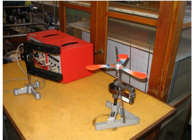
**Bild 2.3** Versuchsaufbau Massenträgheitsmoment
